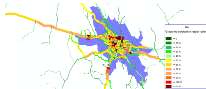
Fig. 2.28. Solicitarea rețelei de infrastructuri rutiere, ZMI
